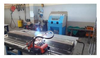
Poi si tratta di ottimizzare i processi di produzione. Qui viene senz'altro in soccorso il TRAC RL Pro, un carrello semovente su guide di alluminio, con velocità regolabile e funzione oscillatore.
